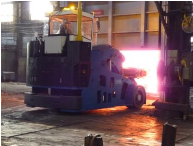
Vecchiato 12to Manipulátor és Löcher II. kemence üzem közben.
