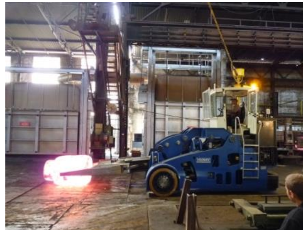
Vecchiato 12to Manipulátor. hátterben a Löcher kemencékkel.
